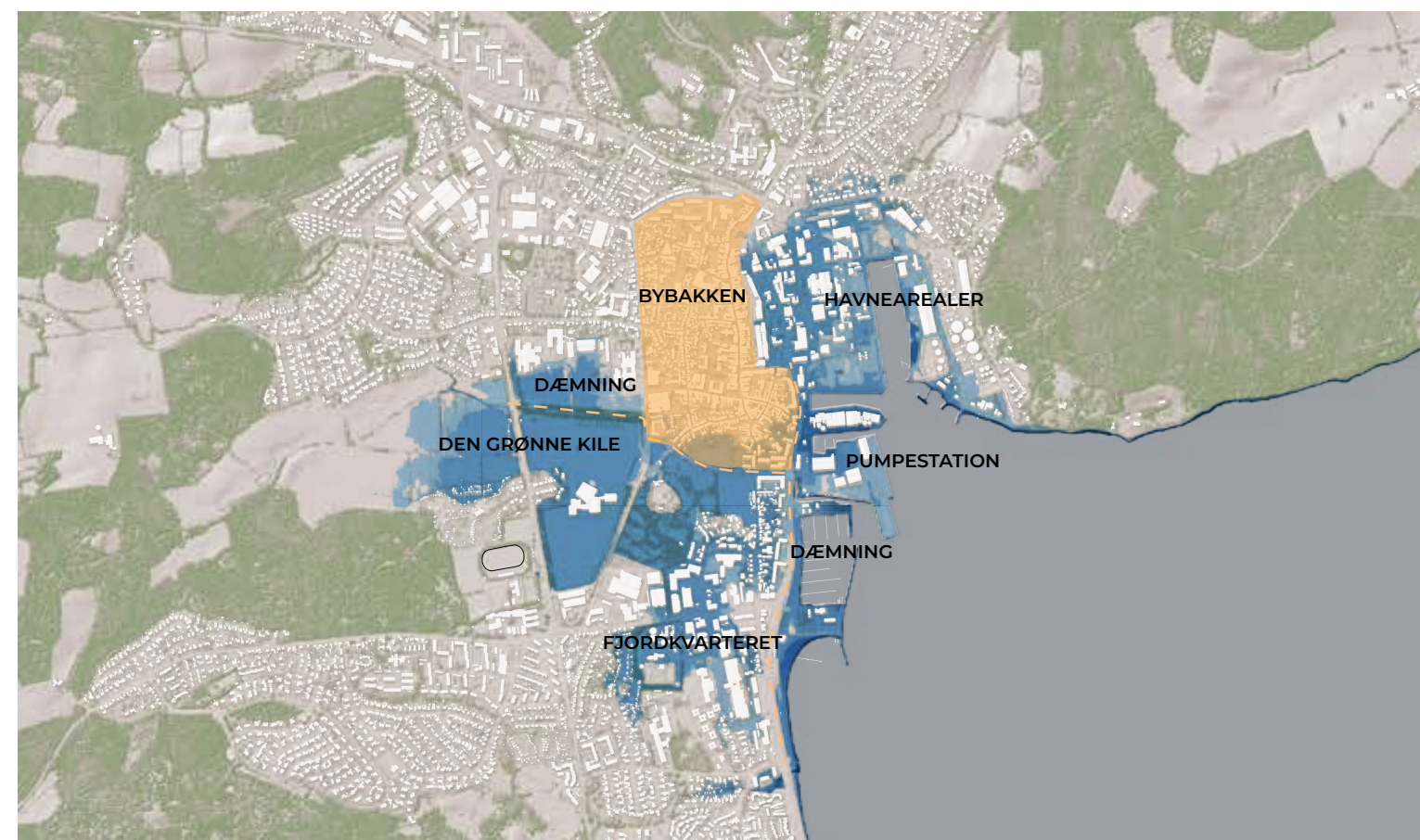
Stormflod: Kortet viser områder med risiko for oversvømmelse ved vandstand 2-3 m over dagligt vande, samt tiltag med dæmninger og pumpestation
