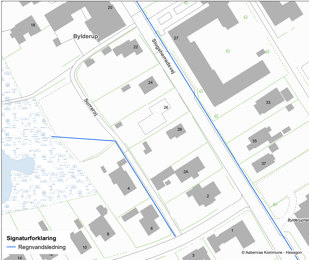
Figur 3-4: Oversigtskort over regnvandsledning beliggende i vejen Surreroj der ændrer ejerstatus.
