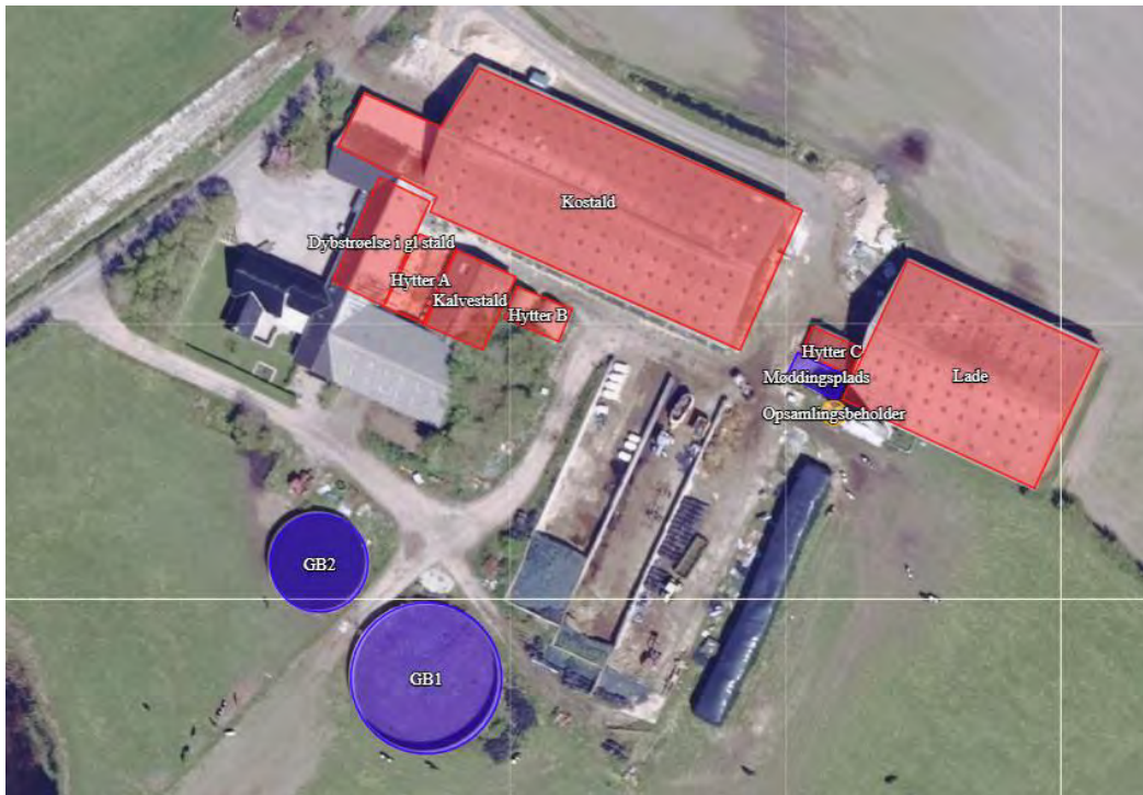
Figur 1 Situationsplan. Rød = stalde. Blå = gødningslager. Gul = andre ny/ændrede driftsbygninger.
