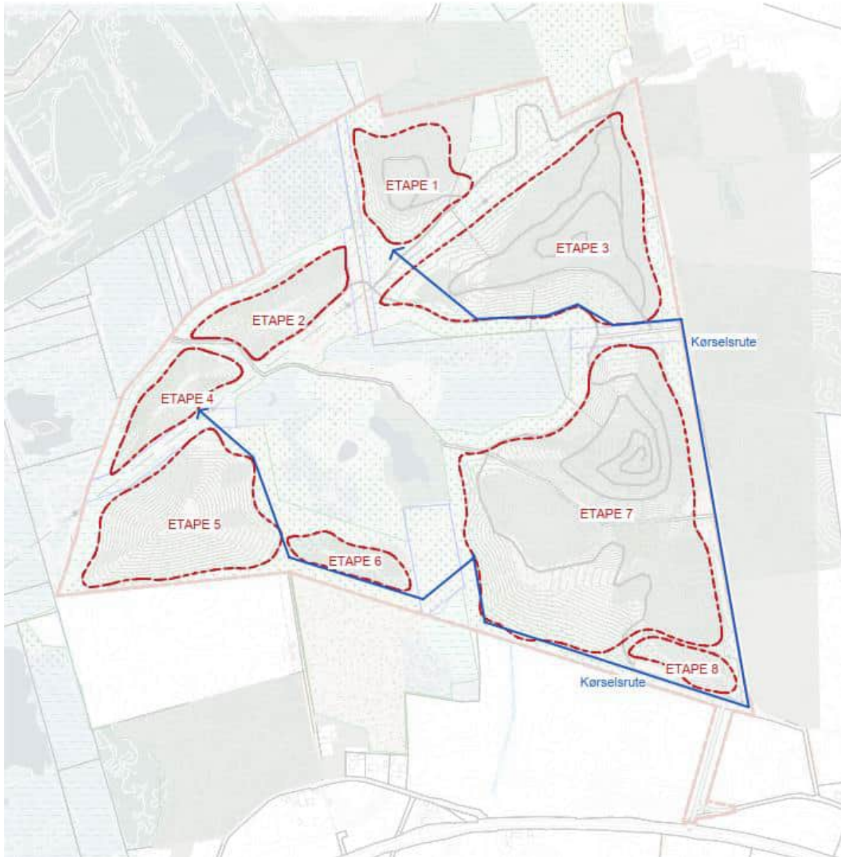
Figur 6.3: Situationsplan over etapeinddeling for etablering af Naturlandskab Møgelmosen. Interne transportveje fremgår ligeledes af situationsplanen.
