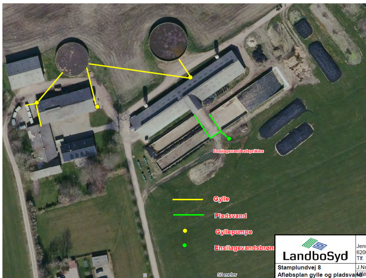
Figur 3. Afløbsplan for stalde, kalveplads og ensilageplads.
