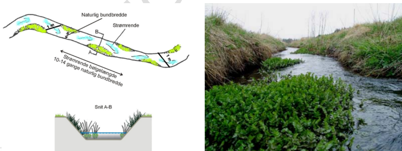
Figur 2: Principskitse og foto af strømrøndens forløb. Eksempel på lille vandløb, hvor den eneste forekommende grønnskeart er Smalbladet Mærke. Den har stor indflydelse på udformningen af vandløbets fysiske tilstand (hydromorfologien) og har stor betydning som levested for vandløbsfaunaen.
