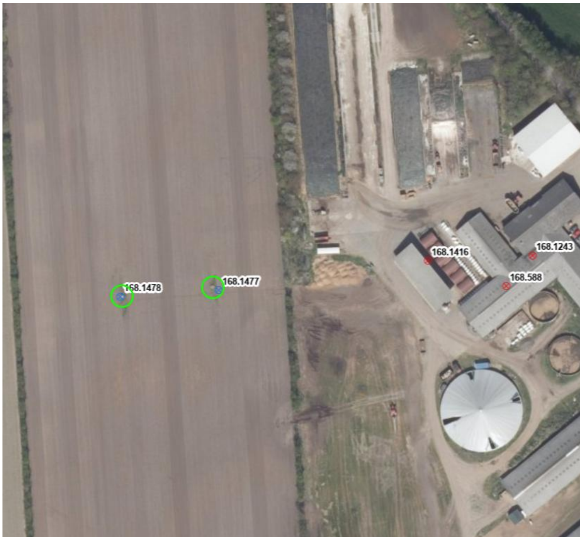
Figur 1: Placering af boring med blå prik og 5 m fredningsbælte med grøn ring. Fredningsbæltet er ikke opfyldt for hverken den ansøgte boring (DGU nr. 168.1478) eller markvandingsboringen (DGU nr. 168.1477).
