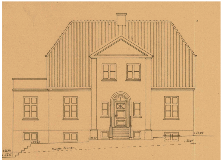
Gamle Kongevej 66 - Originale tegninger. Villaen har mange klassiske bedre byggeskik træk, herunder rødt murværk, rødt vingetegltag med halvvalm, den symmetriske opbygning omkring den store klassicistiske gavlvkist. Vinduesstik er lige, mens den fint bearbejdede snedkerdør har fået en central rolle med buet stik- weblager.dk
