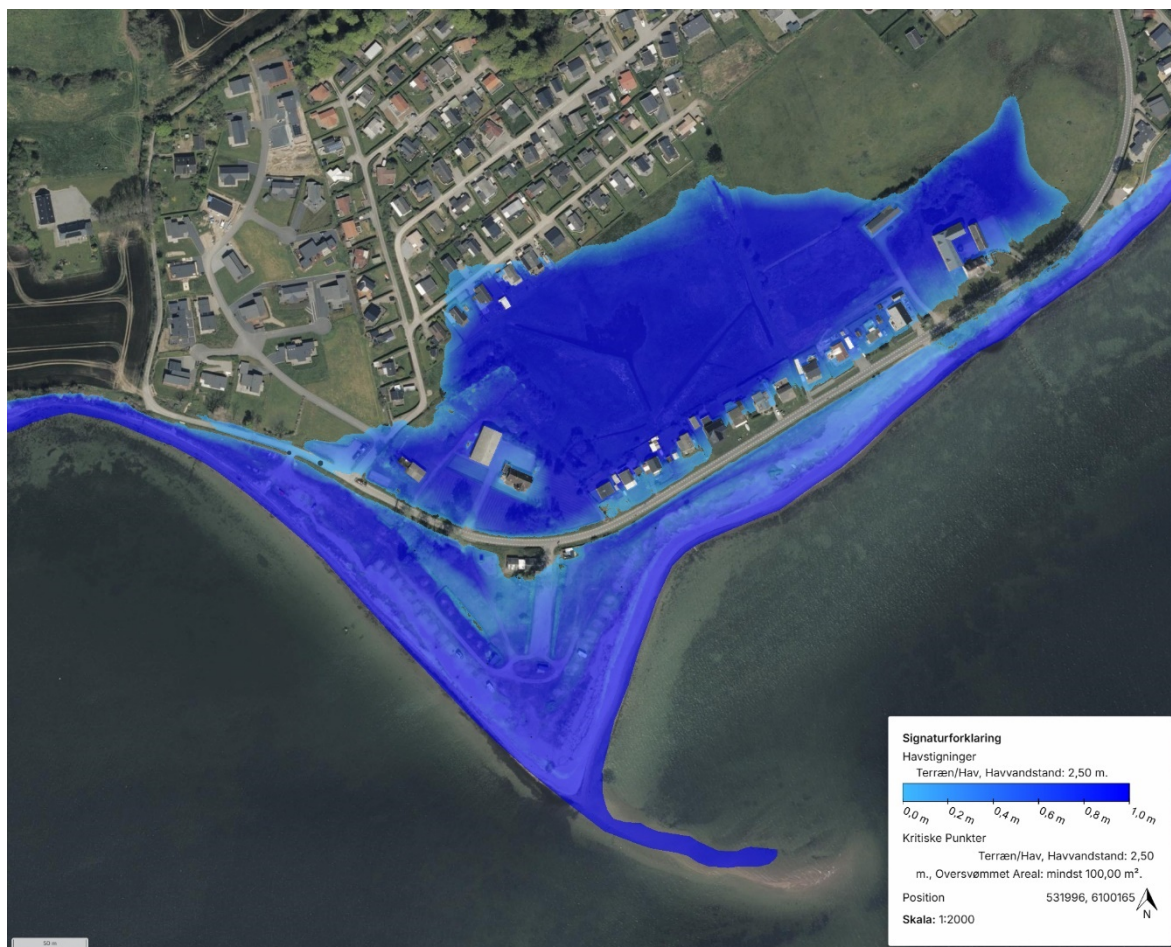
Figur 2: Kortet viser en oversvømmelse ved kote 2,5. Det ses at vejen ved diget bliver oversvømmet (hvis ikke vejen lukkes) og vandet forplanter sig til baglandet, hvor sommerhusene er placeret.
