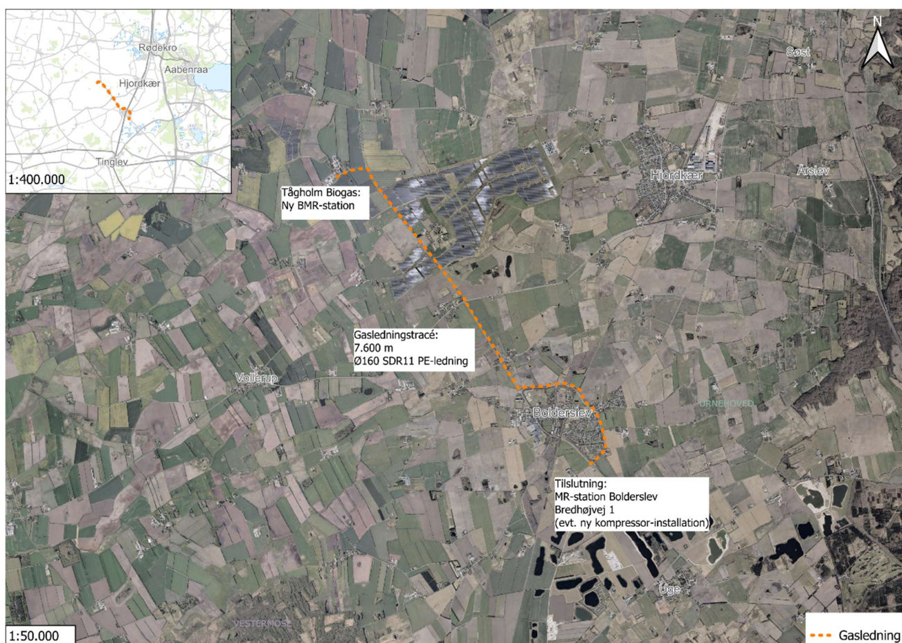
Figur 4: Linjeføring for gasledning
