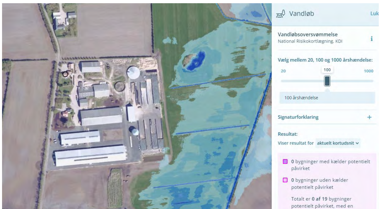
Figur 27: Områder der er sårbare for oversvømmelse fra vandløb. Kilde: kamp.miljoportal.dk
