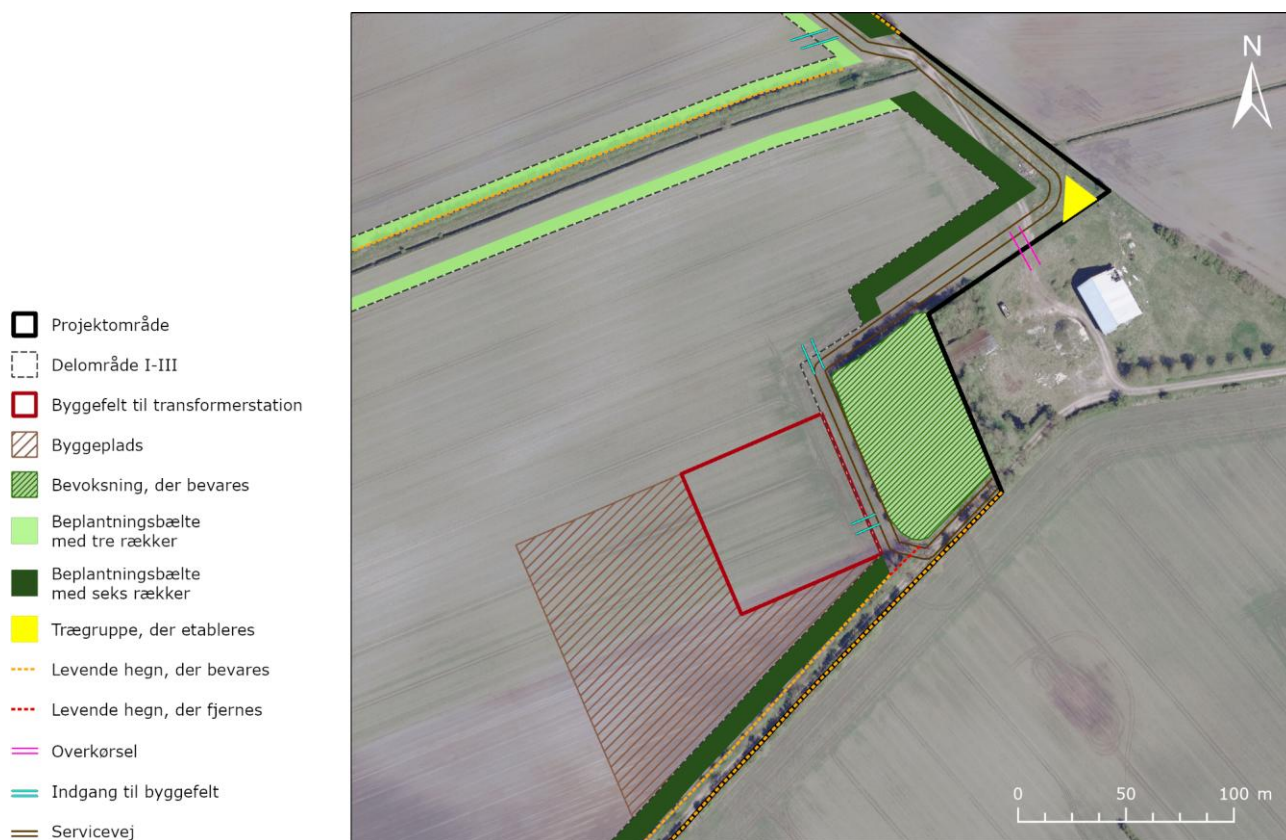
Figur 6-16 Markering af én central servicevej, byggeplads ved transformerstationen indgange til byggefelter.
