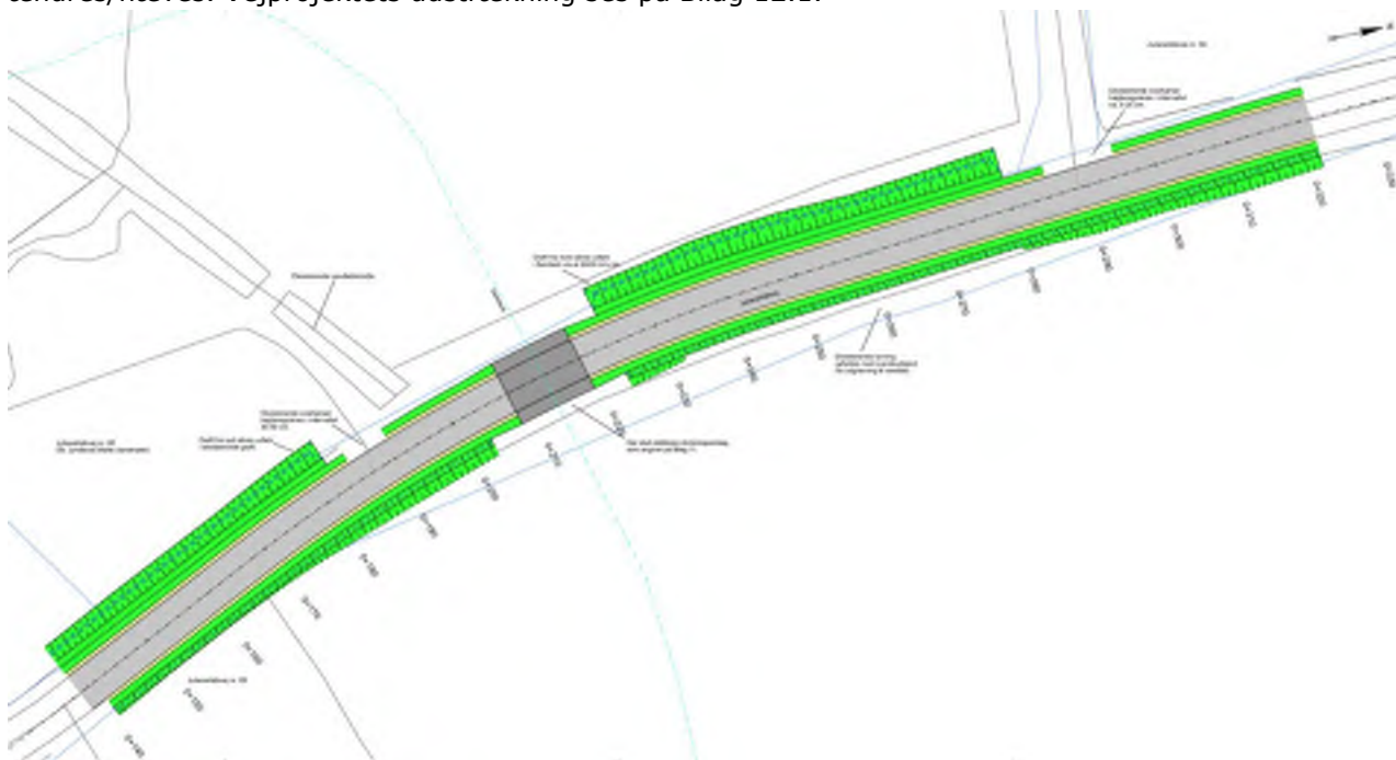
Figur 22 Udstrækning af Julianehåbvej, som skal hæves i forbindelse med etablering af den nye vejbro. (Bilag 12.1)
