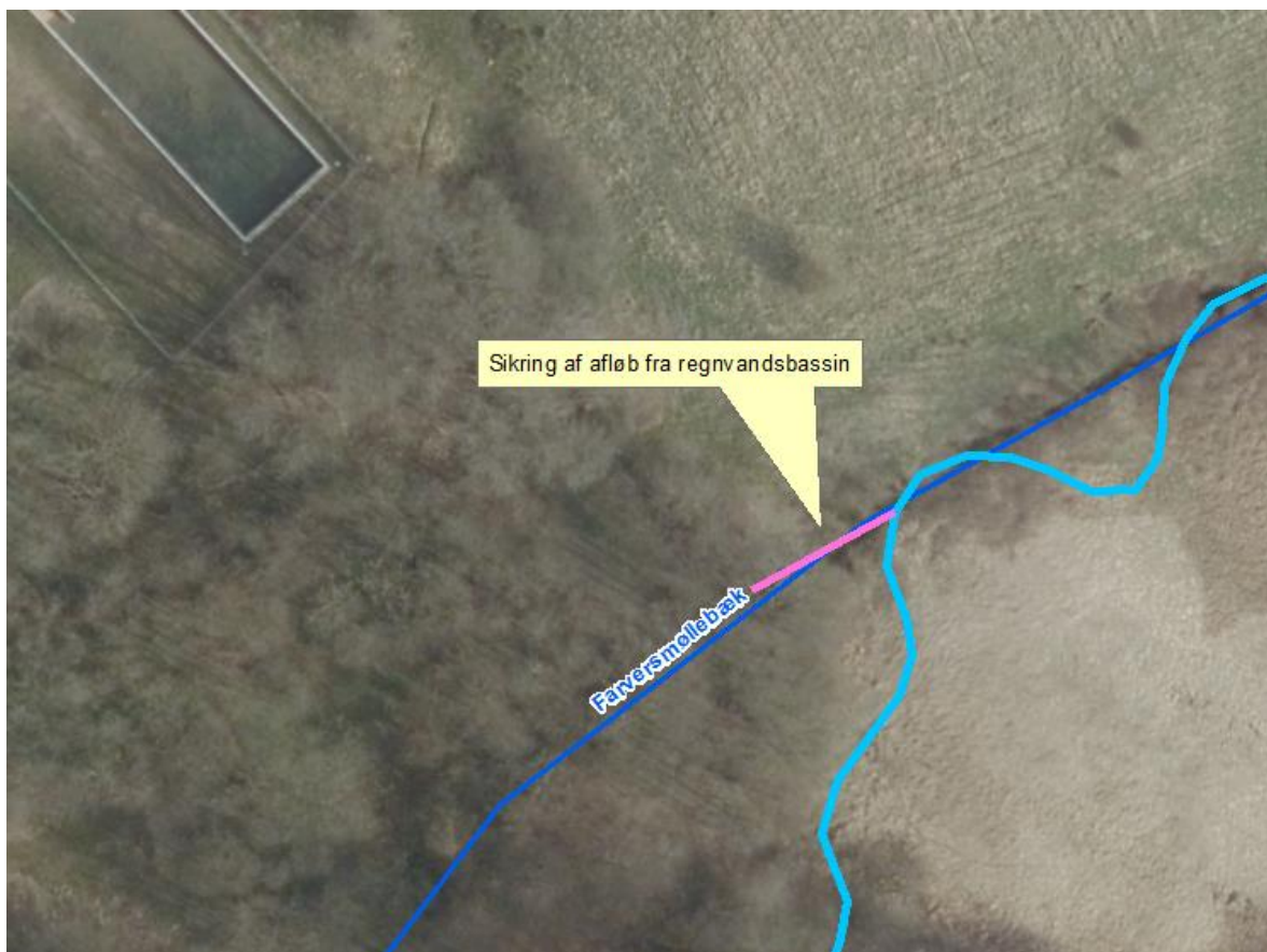
Figur 25 Etablering af grøft til afledning af vand fra regnvandsbassin til nyt forløb af Farversmøllebæk.
