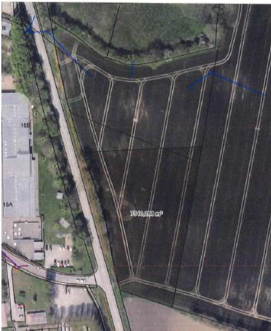
Figur 4: En del af ansøgningsmaterialet, som viser størrelsen på den del af matriklen, som udlægges midlertidigt af Arwos til anvendelse som skurby, oplag af rør/brønde, og andre materialer, parkeringsplads for entreprenørmaskiner samt karteringsplads for opgravet jord.
