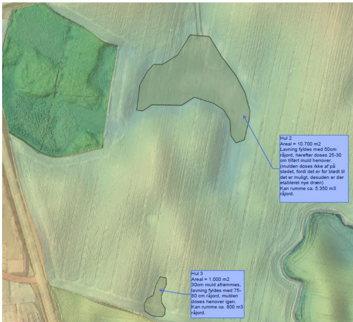
Figur 8: Viser hvor jorden fra regnvandsbassinet påfyldes.
