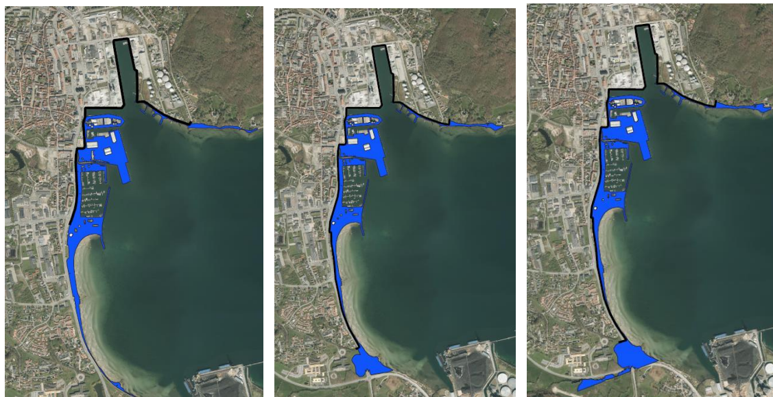
Figur 9.2: Udbredelse af stormflodsbarriere ved sikring til henholdsvis kote +2,50 meter, kote +3,35 meter og kote +4,35 meter.
