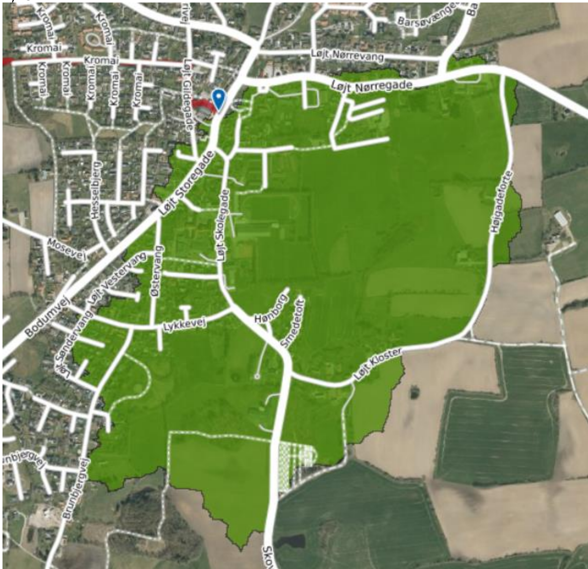
Bilag 4. Vandløbsoplandet til opstrøms Storegade illustreret via Scalgo. Arealet er ca. 1,15 km 2 .
