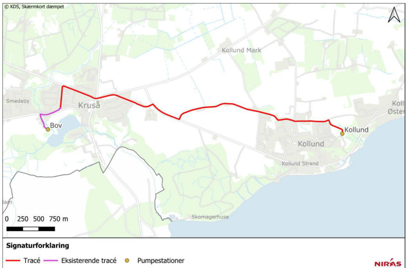
Figur 2.1: Ledningstracé fra Kollund Renseanlæg til Bov Renseanlæg.
