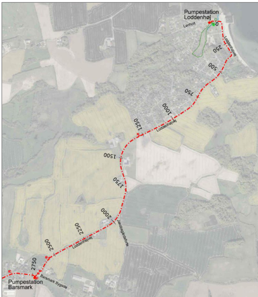
Figur 4-1 Ledningstracé fra Pumpestation Loddenhøj til Pumpestation Barsmark.
