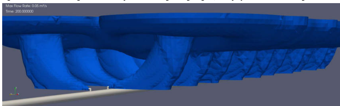
Figur 7-1: Diffusoranlæg i Aabenraa Fjord. Blandingsberegninger for høj hydraulisk belastning.
