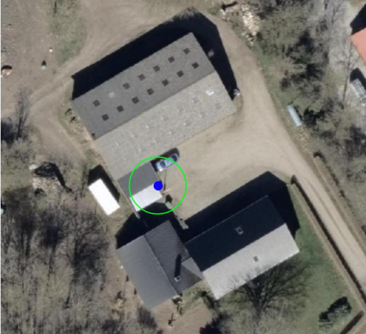
Figur 1: Placering af boring med blå prik og 5 m fredningsbælte med grøn ring.
