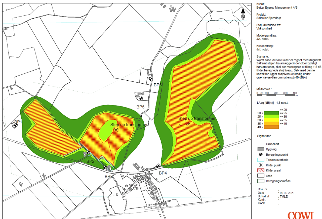
Figur 10-1: Støjdbredelseskort 1,5 m over terræn ved fuld drift over hele døgnet varende til "Worst case scenariet". Kortlægningen er udført i SoundPLAN version 8.1 update 04-02-20.
