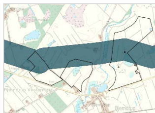
Planlagt gastransmissionsledning (400 m bred korridor), KP 2015.
