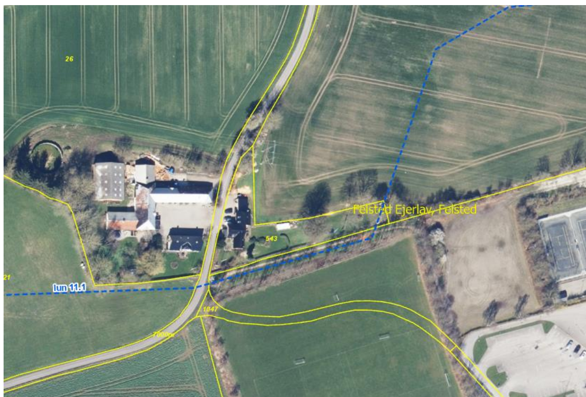
Figur 2: Oversigtskort over Bjisselbæks forløb. Vandløbet er rørlagt på den aktuelle strækning.
