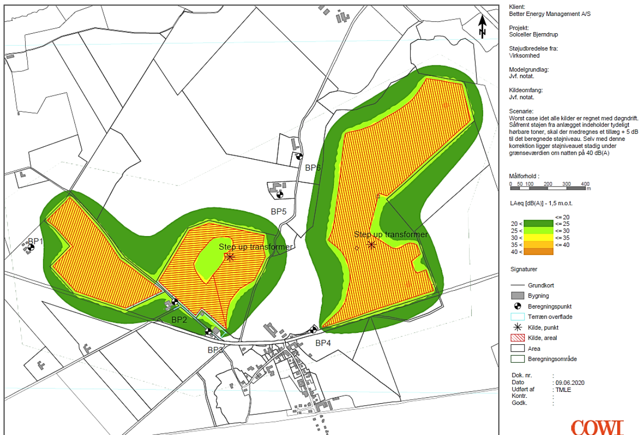
Figur 7-1: Støjvurderingskort 1,5 m over terrænet ved fuld drift over hele døgnet varende til "Worst case scenarier". Kortlægningen er udført i SoundPLAN version 8.1 update 04-02-20.
