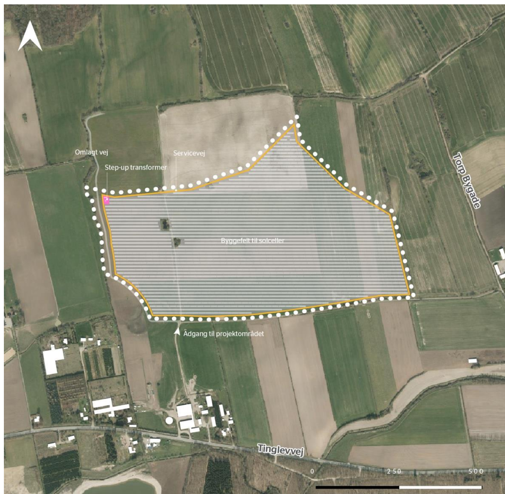
Figur 5.1: Afgrænsning af projektområdet der er vist med hvide prikker. Indenfor projektafgrænsningen ses princip for placering af solenergianlægget, herunder solcellepaneler, step-up transformer, samt intern servicevej.
