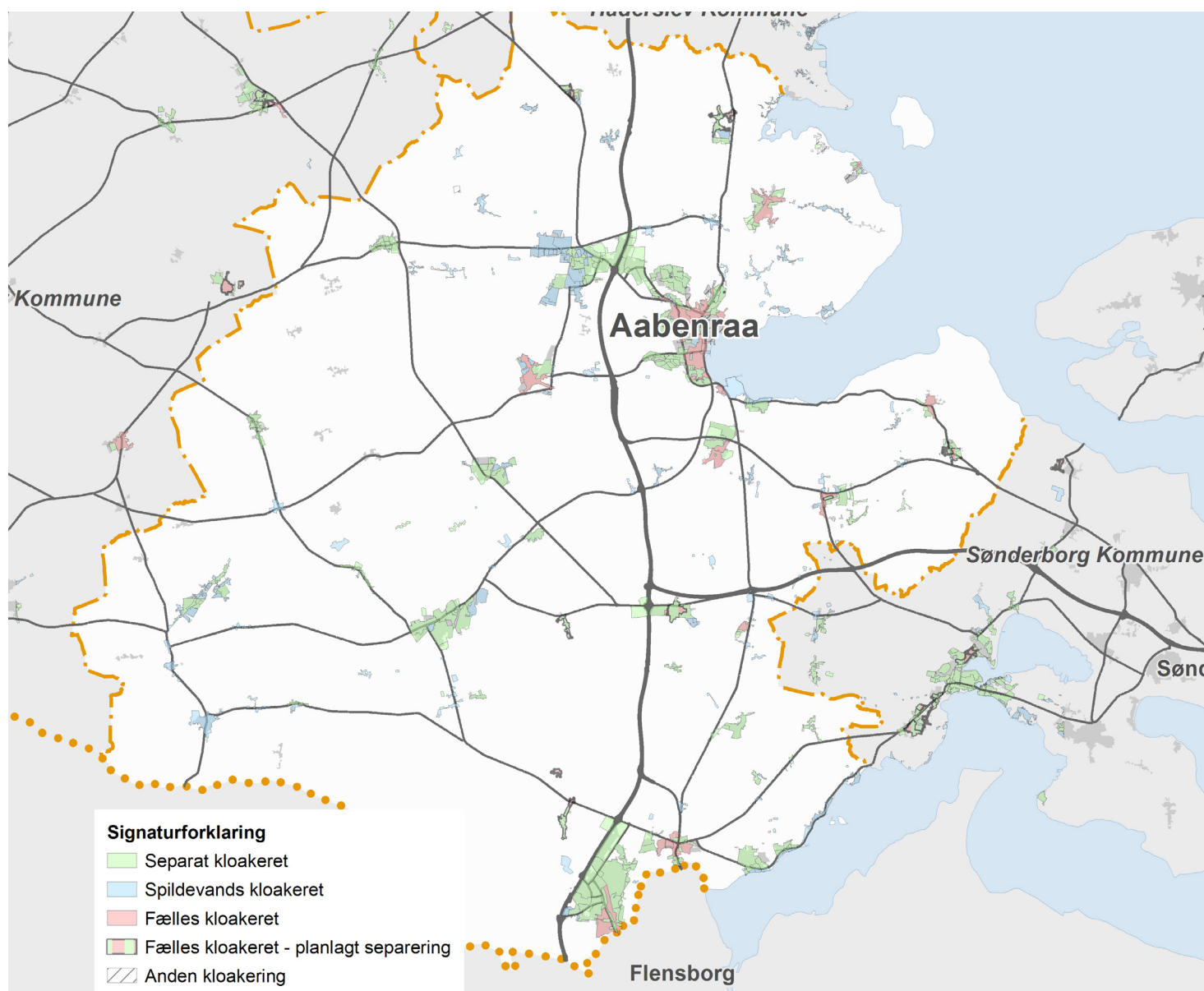
Figur 2.1 - Status over kloakoplade i Aabenraa Kommune.
